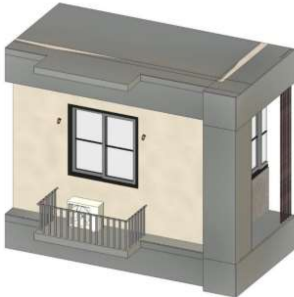
圖 2-1、雨遮設置室外機範例
