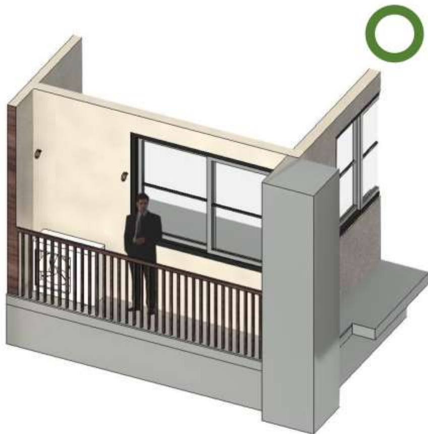
圖 2-2、露樑設置室外機範例
