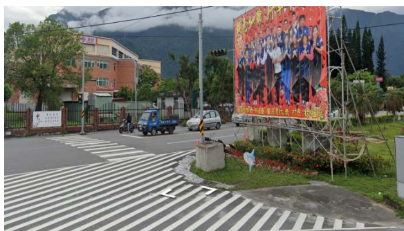
11. (光復路)通往國軍花蓮總醫院北埔總院區之路口處，行穿線銜接槽化線且重疊
